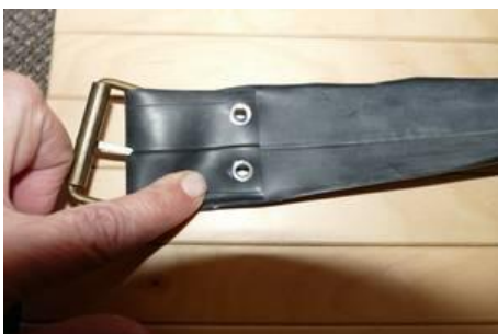
13. Ösen mit Ösenzange anbringen
