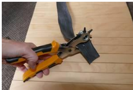
8. Für Dorn mit Lochzange/Locher lochen
