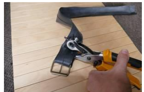
12. Mit Lochzange/Locher lochen
