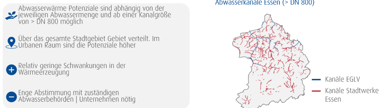
Abbildung 27: EE-Potenzial in Essen – Abwasserkanäle geeignet für Abwasserwärme
