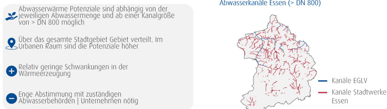
Abbildung 27: EE-Potenzial in Essen – Abwasserkanäle geeignet für Abwasserwärme
