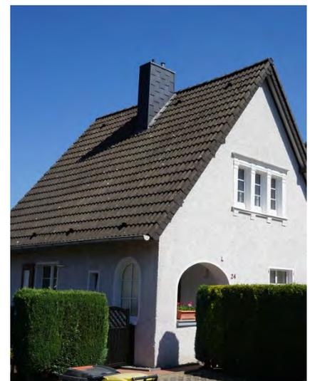
Beispiel: Kopfgebäude, das giebelständig steht. Eine Veränderung des Giebel Fensters scheidet wegen der Fenstergestaltung aus. Ein Dachflächenfenster ist hier verträglicher, als eine neue, zusätzliche Gaube.
