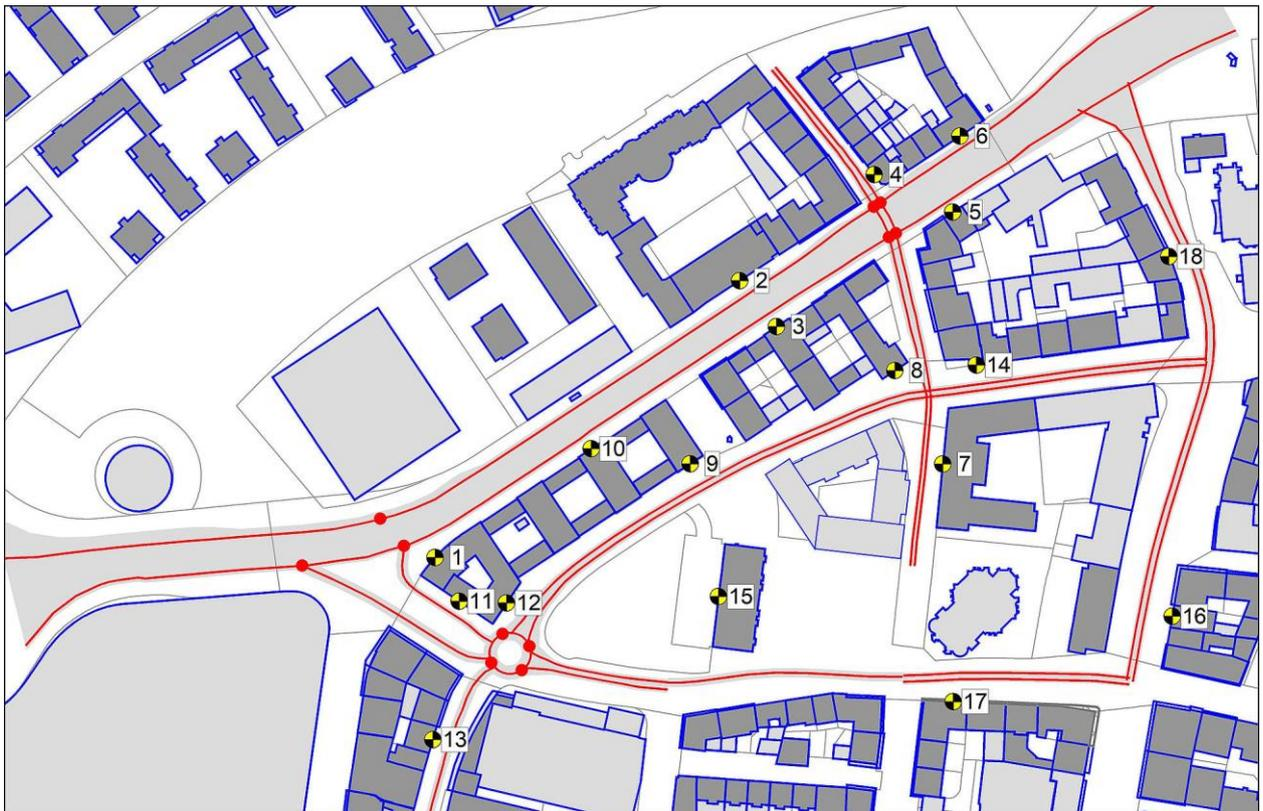
Abbildung 5: Auszug aus dem Berechnungsmodell nach DIN 18005 [9] im Prognose-Planfall
