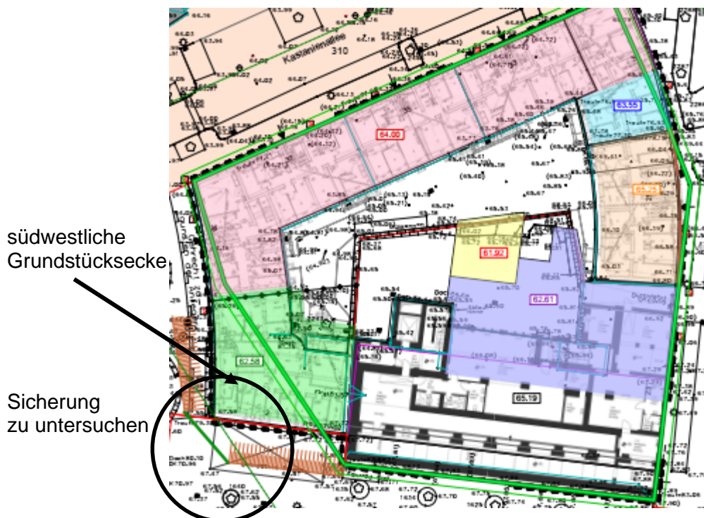
Bild 5: Neubaugrundriss (grüne Linien) über Bestand (Quelle: GWI, Tragwerksvorentwurf Verbauplanung/ Bestand vom 06.09.2022)
