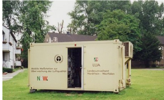
Abbildung 1: MILIS-Meßcontainer (4,3 m x 2,4 m x 2,3 m)
