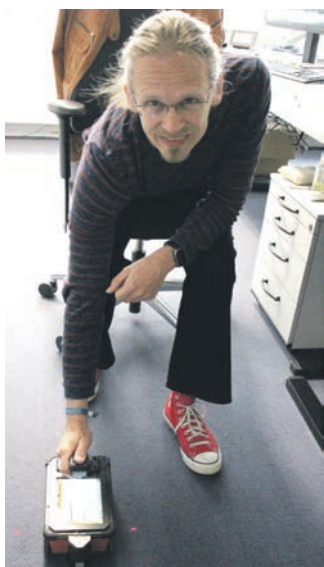
Blick durch Wände und Böden: Das Geo-Radar-Handgerät findet Leitungen, Hohlräume, Eisengitter oder defekte Strukturen.
