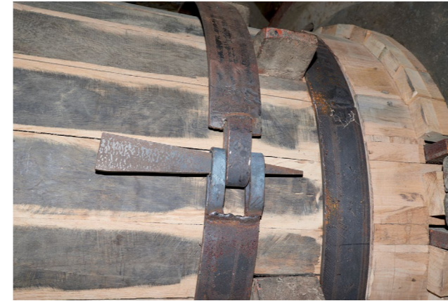
Hammerwelle mit neuer Beplankung und Fixierungsbandagen mit Keilverschluss, 2018 © Achim Mikuscheit/Ruhr Museum
