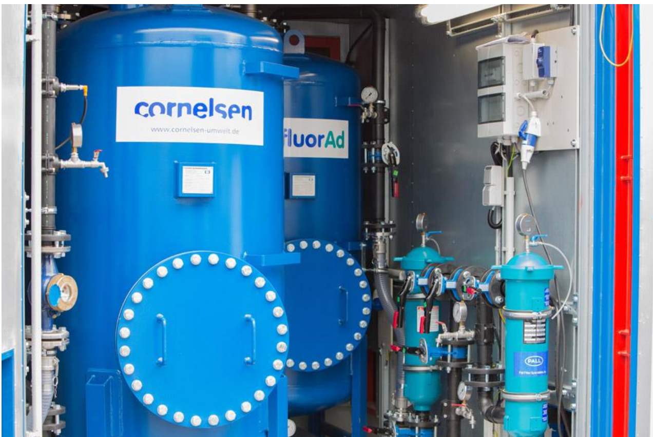
Die "Mobile Löschwasser-Behandlungsanlage" der Cornelsen Umwelttechnologie GmbH aus Essen. Foto: Claudia Anders, EWG
